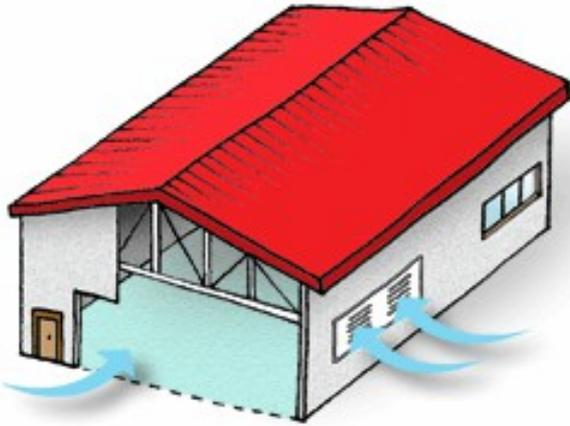
Le aperture (porte, finestre, etc.) e le prese d'aria proveniente dall'esterno, inserite in una struttura edilizia atte ad assicurare una ventilazione naturale dei vari ambienti
